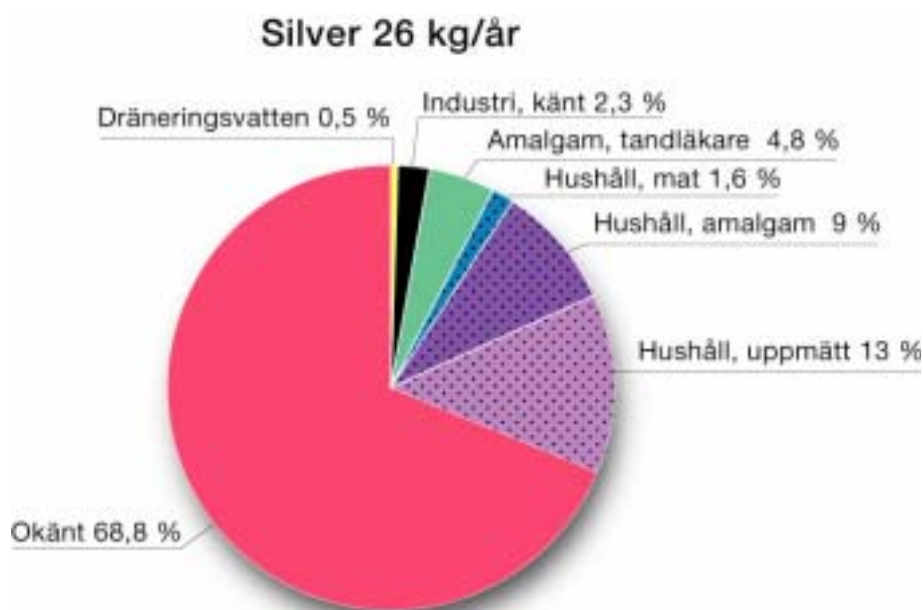
Figur 15. Beräknade och uppmätta källor till silver i inkommande avloppsvatten till Bromma avloppsreningsverk i Stockholm
